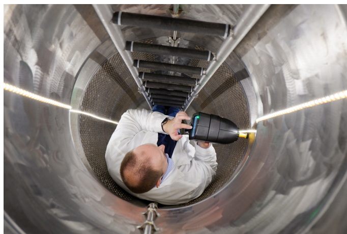
8. ábra: A gőzfejlesztő hőcserélő csöveinek APR vizsgálata
