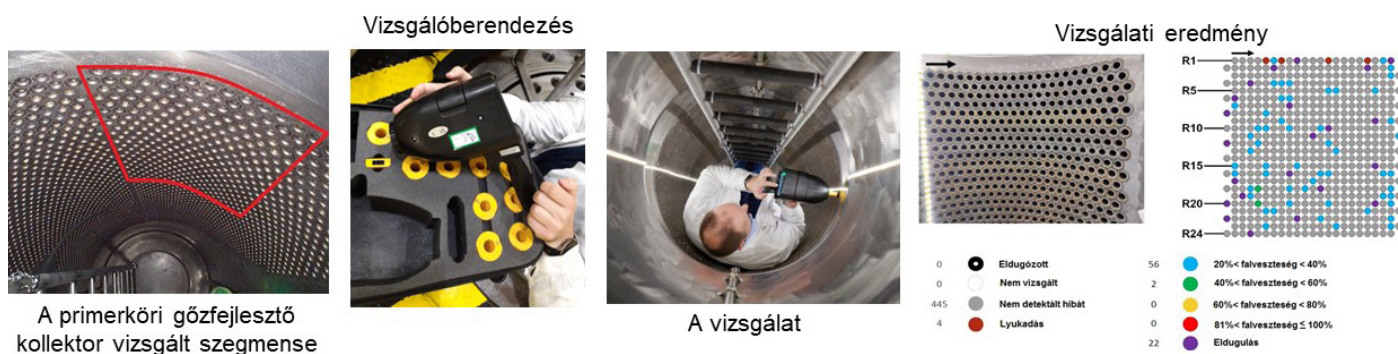
3. ábra: A primerköri gőzfejlesztő hőcserélő csöveinek APR vizsgálata [2]
