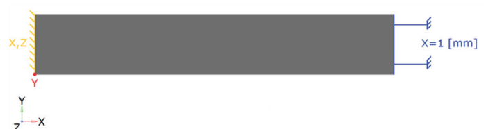
6. ábra: A végelelemes modell peremfeltételei
