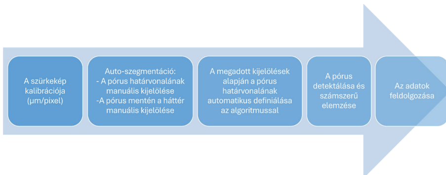
5. ábra: A töretfelületekről pásztázó elektronmikroszkóppal készített felvételek képelemzésének folyamata
