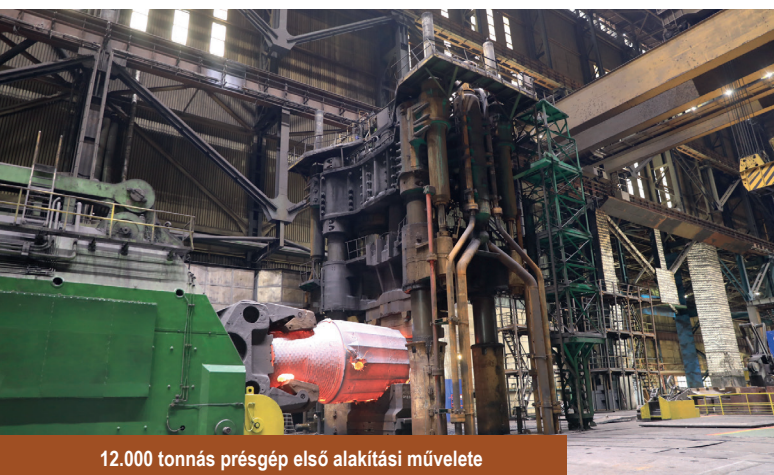
Buga befogása az első kovácsolási művelethez
