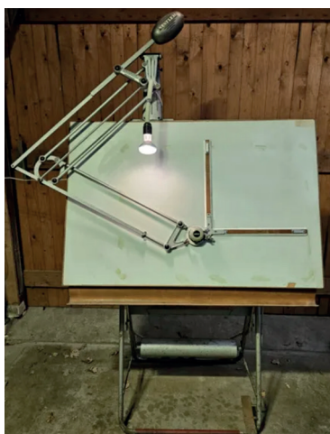
Klasszikus mérnöki rajztábla paralelogramma mechanizmussal
