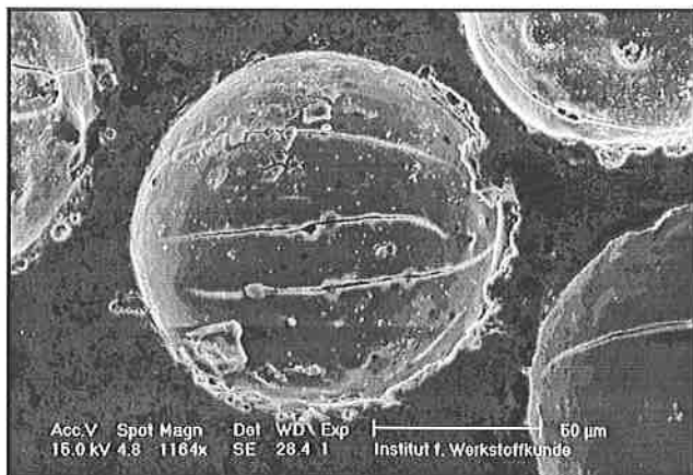
13. ábra. 8% alakváltozásnál a nagy alakítási fok csak a csúszsósík környezetére koncentrálódik. Attól távolabb kisebb az alakítási fok
