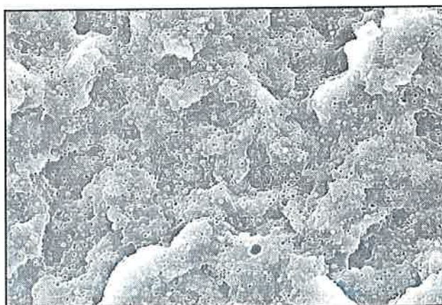
6. ábra. Polipropilén blokk kopolimer (9% etilén tartalom) törési felületéről készített SEM felvétel [2].
