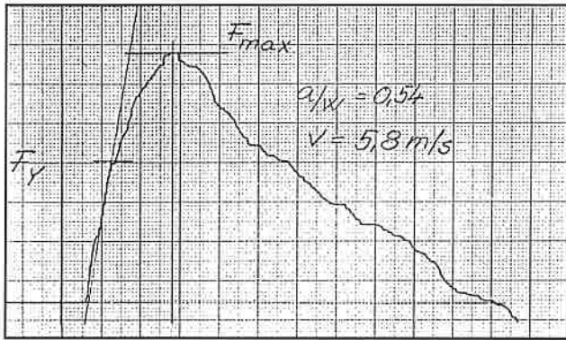
3. ábra. Az erő változása az idő függvényében; műszerezett ütővizsgálat seinek a szakirodalom is alátámasztotta [12]. A pontos erőméréshez szükségessé vált az ütés során lejátszódó folyamatok megismerése. Az ütközéskor az erőmérő testben rugalmas hullámok keletkeznek, amelyek periódus ideje:
