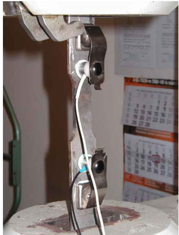
1. ábra. Szakítóvizsgálat a feszültség és az akusztikus-emissziós jellemzők (aktivitás, intenzitás) közti kapcsolat feltérképezésére
