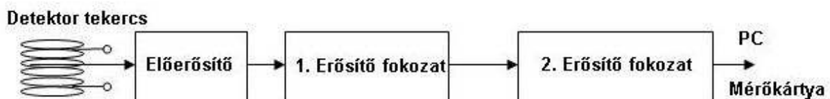
5. ábra. A zaj-erősítő rendszer blokkdiagramja – Fig. 5: Block diagram of the noise amplifier system
