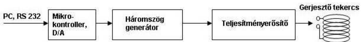
4. ábra. A gerjesztő rendszer blokkdiagramja – Fig. 4: Block diagram of the generating system
