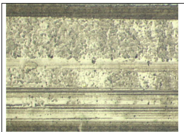
8. ábra – Kezdődő felületi kifáradás, apró, kis átmérőjű kipattogzott részek (N ≈ 200x) Figure 8 – Surface fatigue in the beginning stadium with small parts fallen out (M ≈ 200x)
