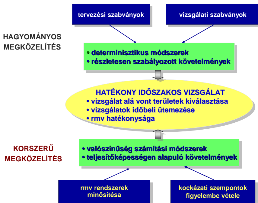
2. ábra A roncsolásmentes vizsgálatok hatékonyságának változása Figure 2. Change in effectiveness of non-destructive testing
