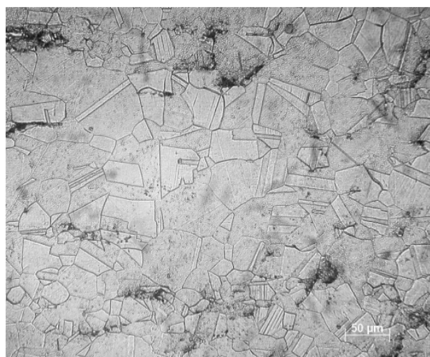
3. ábra A W.Nr. 1.4547 minőségű acél szövetszerkezete Figure 3 Microstructure of material W.Nr. 1.4547
