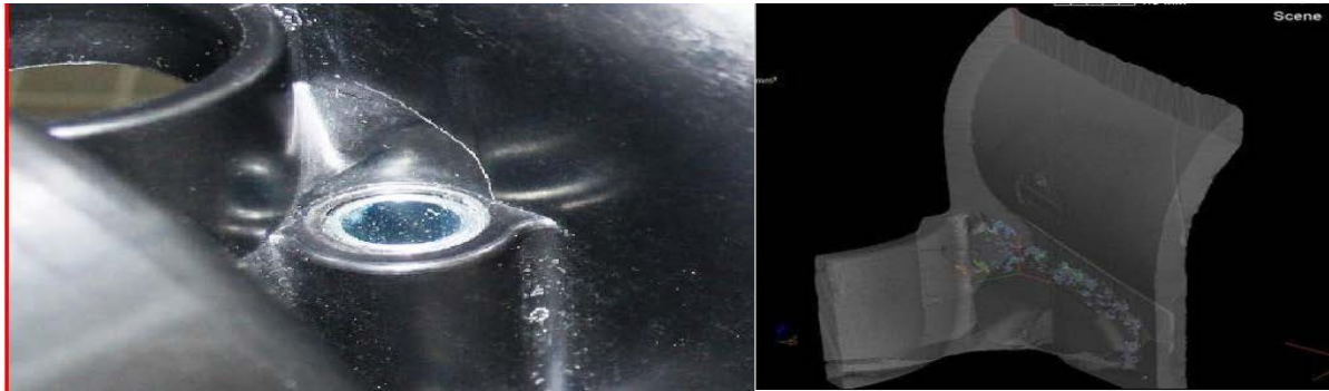
2. ábra: Kompozit ház hiba okának elemzése
