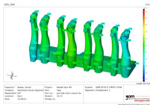
3. ábra: Geometriai méretek ellenőrzése
