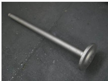
5. ábra: Féltengely UH vizsgálattal kimutatott belső repedése
