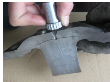
5. ábra: Féltengely UH vizsgálattal kimutatott belső repedése
