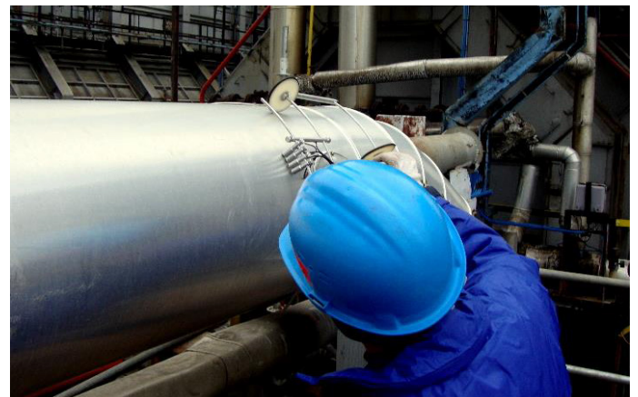
27. ábra: MMM vizsgálat szigetelésen keresztül
