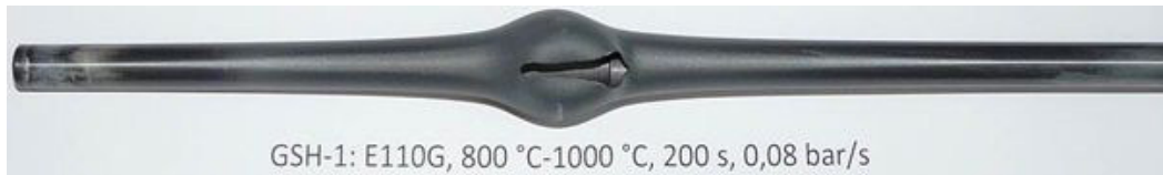
3. ábra: E110G mintadarab a szekunder hidridizációs kísérlet után
