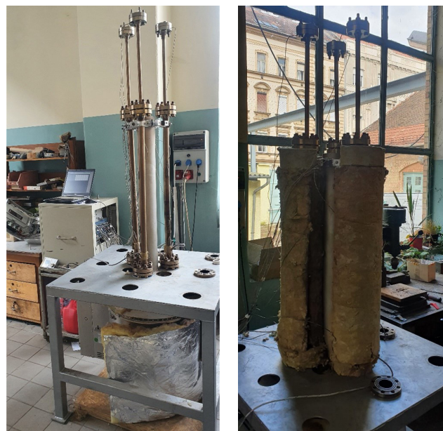
9. ábra: A mérőberendezés felépítése bal: szigetelés nélkül, jobb: első réteg szigeteléssel
