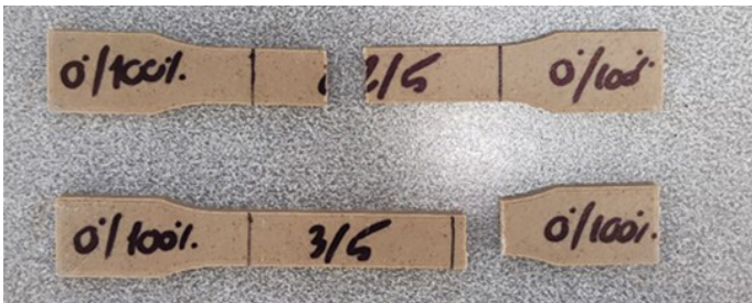
6. ábra: Jeltávon belüli és kívüli szakadás
